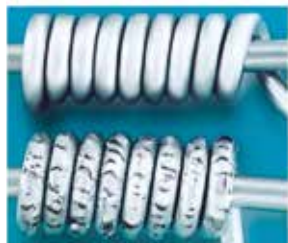
A) Filo d'acciaio Tutor® Trigalv® B) Filo a zincatura non aderente
