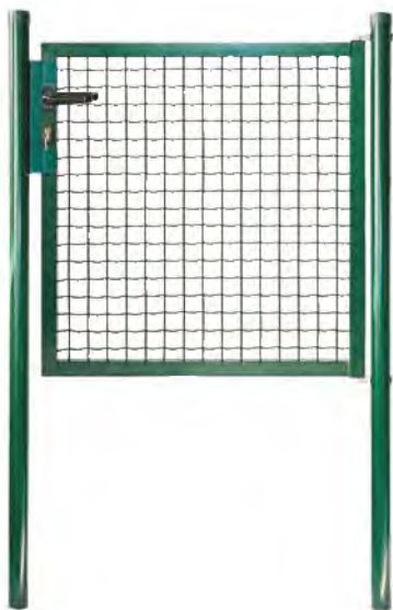
Cancelli pedonali a battente con pali Col Verde - Maglia 100x50 mm Telaio tubolare quadrato 40x40 mm Maniglia plastica - Battente in ferro Serratura standard europeo con cilindro
